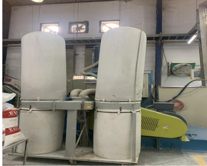
Hình 3.2. Hình ảnh bố trí thiết bị lọc bụi túi vải Dr. Clean Air
